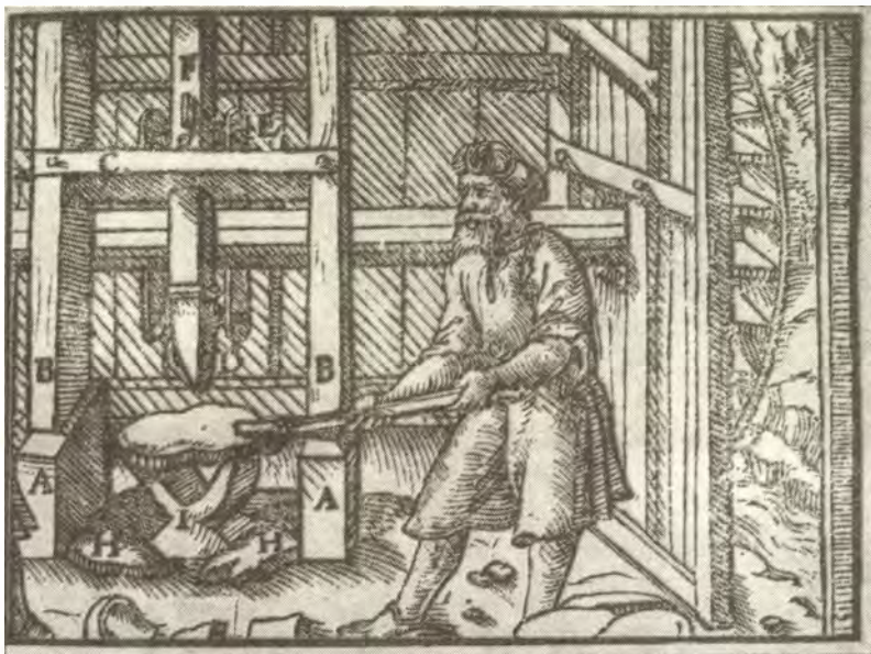
4. ábra. Buca darabolásra alkalmas vízajtású pöröly Agricola: De Re Metallica c. könyvből
