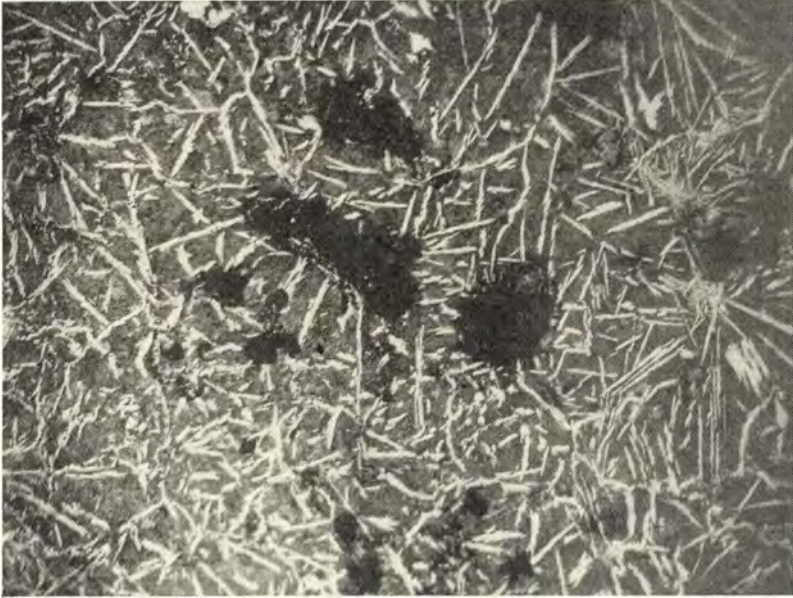
1. Soproni buca szövete: perlites alapon cementit tűkristályok. A felvétel az öntött kovácsolt szövet átmenetét mutatja. A kovácsolás nagyrészt összenyomta az üregeket, a cementit tűkristályok részben szétfőredtek illetve összegyűrdtek. N = 20 \times . Maratás: 3%-os alkoholos salétromsav
