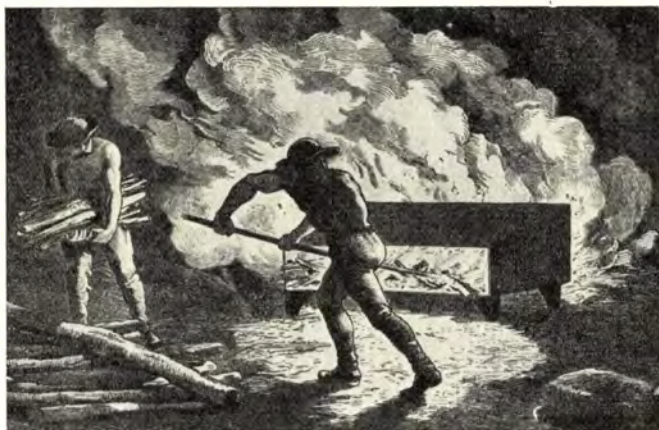
1. Tűzzel való jövesztés a XIX. század első felében. Elöl a „vasmacskának” nevezett „tűzirányító” vaslemez szekrény. — N. N.: Návšteva bani. Praha, 1873 című munkából
